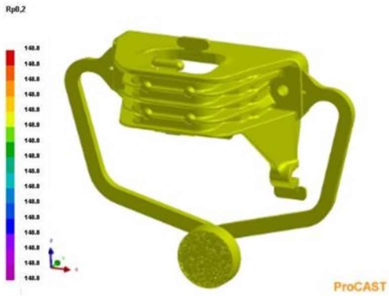
Figure 95: Cartographie de la limite élastique(MPa) de l'alliage 3
