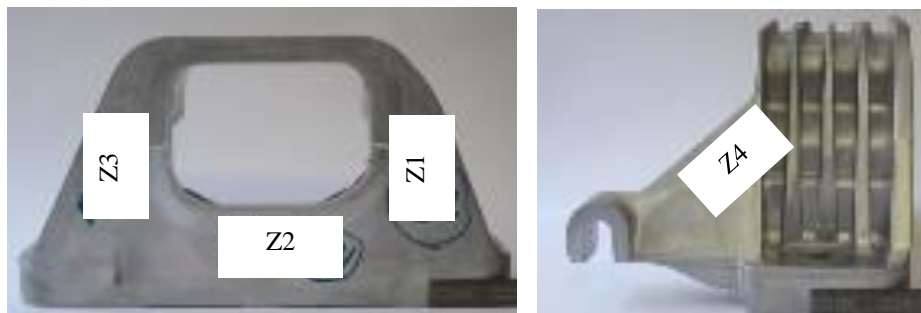
Figure 31: Zones de prélèvement des éprouvettes de caractérisation
