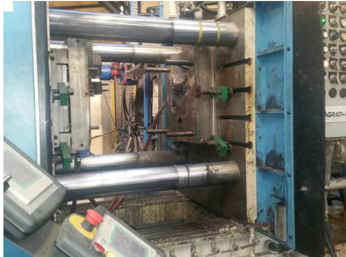
Figure 29: La presse et le moule utilisés pour les coulées
