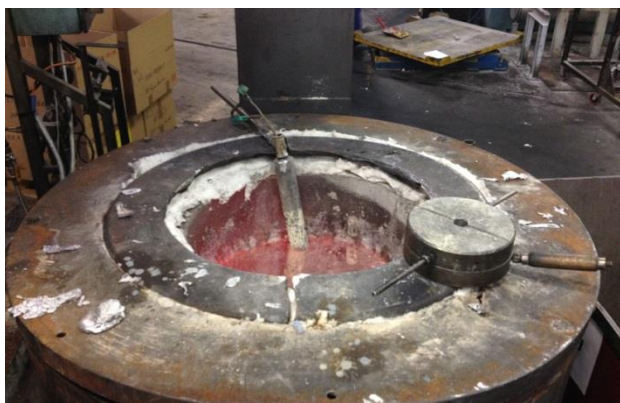
Figure 28 : Four de maintien utilisé lors des coulées
