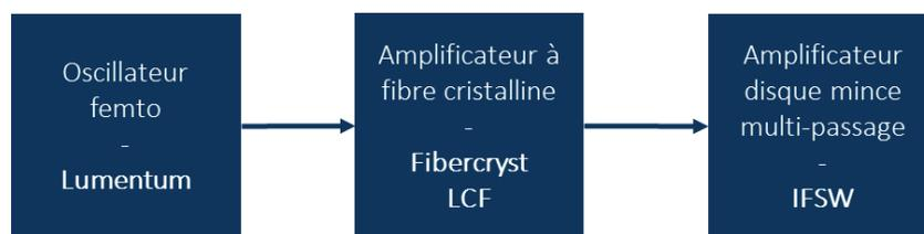
Figure I-12 : Architecture globale du système laser développé dans le cadre du projet Razipol.
