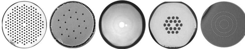
Figure II-12 : différentes fibres à larges aires modales : de gauche à droite, DMF, LPF, CCF, LCF.
