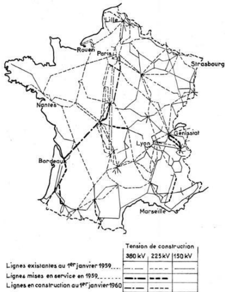
Fig. 14. — Le réseau de transport de force.
