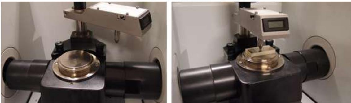
FIGURE 2.8 – Essai de spectroscopie infrarouge à réflexion totale atténuée (ATR)
