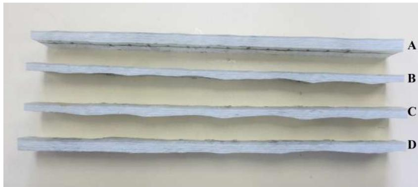
FIGURE 4.38 – Profil des éprouvettes extraites du tube utilisé avec le corindon
