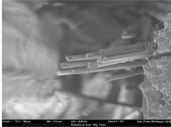
FIGURE 3.70 – Image MEB d’une éprouvette rompue en essai statique : rupture de fibres (échelle en vert 100  $\mu\text{m}$ )
