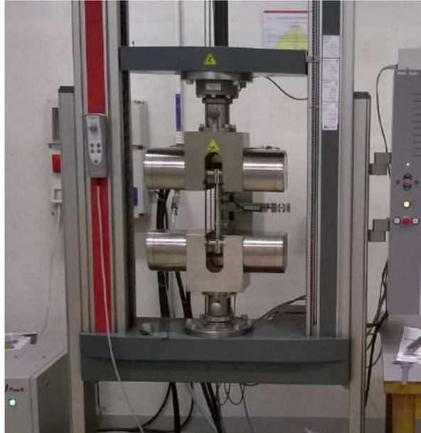
FIGURE 2.11 – Machine d'essai statique : Zwick 100 kN
