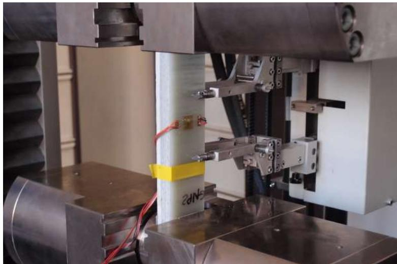
FIGURE 3.18 – Traction simple et instrumentations : éprouvette de type B
