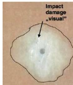
FIGURE 1.8 – Délaminage après un impact [Imielińska *et al.*, 2008]
