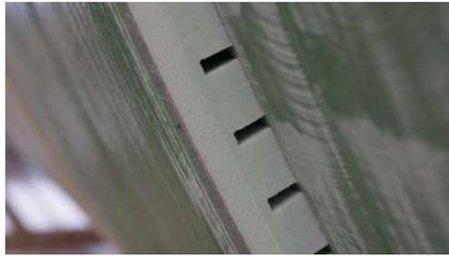
FIGURE 1.4 – Matériau sandwich fait par enroulement filamentaire [Plasticon Composites]
