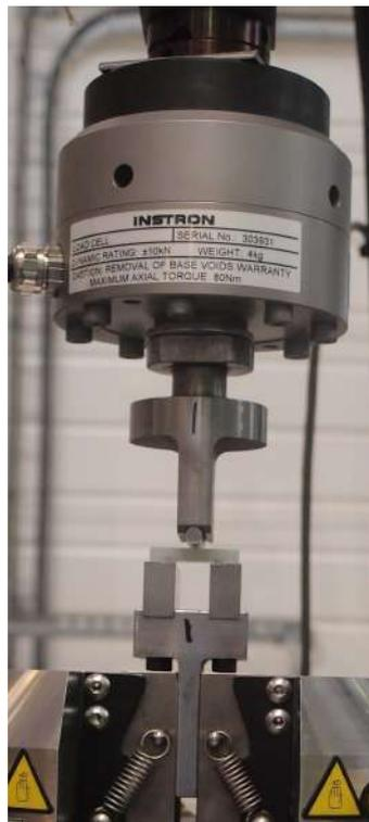
FIGURE 3.58 – Montage pour les essais de cisaillement suivant la norme ASTM D2344 : éprouvette de type A
