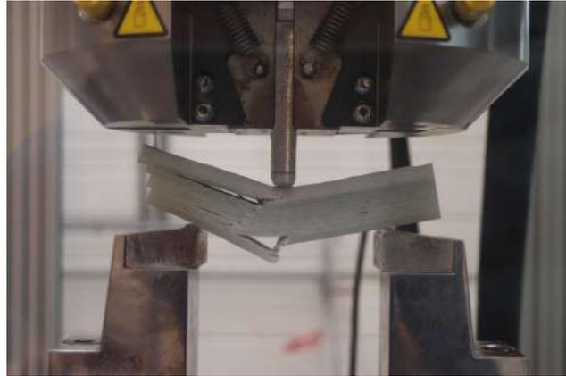
FIGURE 3.62 – Rupture d'une éprouvette de type B après un essai de cisaillement
