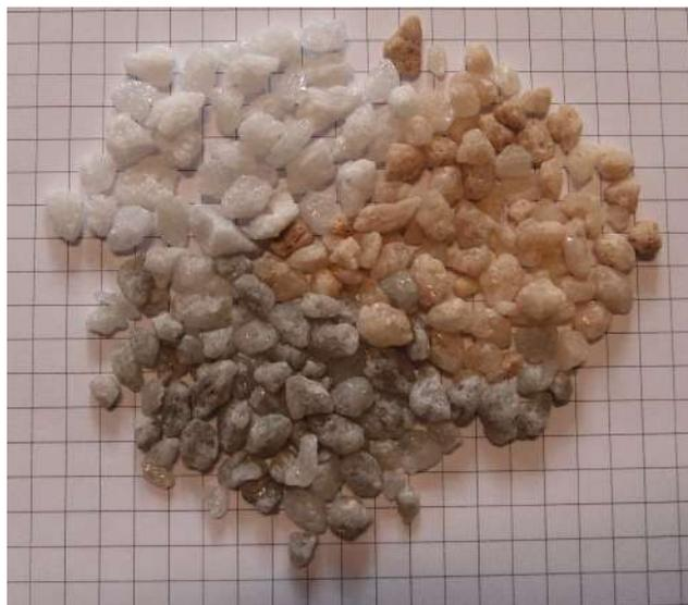
FIGURE D.2 – Corindon avant et après usure
