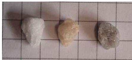
FIGURE D.1 – Echantillons de corindon, de gauche à droite : brut, après usure sur du composite et après usure sur de l'acier
