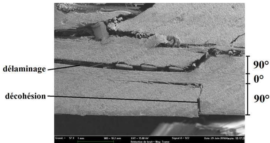
FIGURE 3.57 – Image MEB d'une éprouvette rompue en essai statique : face tendue (échelle en vert 1 mm)
