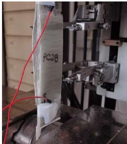
FIGURE 3.9 – Rupture de l'éprouvette après une traction simple
