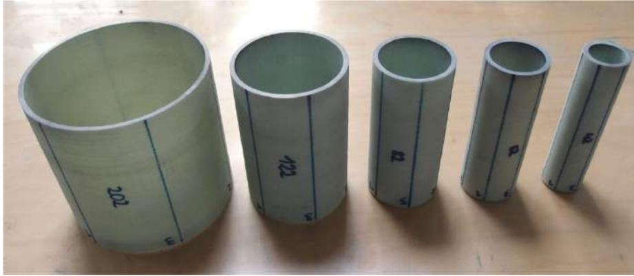
FIGURE 3.31 – Tubes en verre/époxyde de différents diamètres
