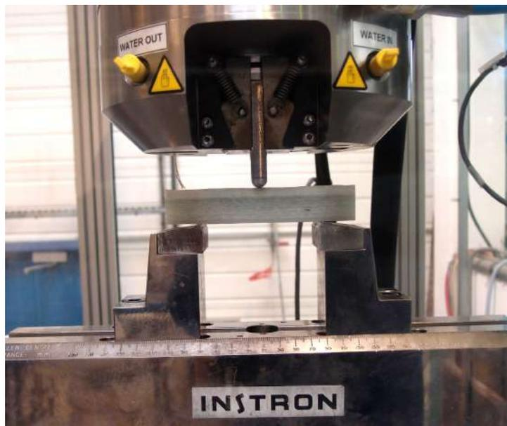
FIGURE 3.61 – Montage pour les essais de cisaillement suivant la norme ASTM D2344 : éprouvette de type B
