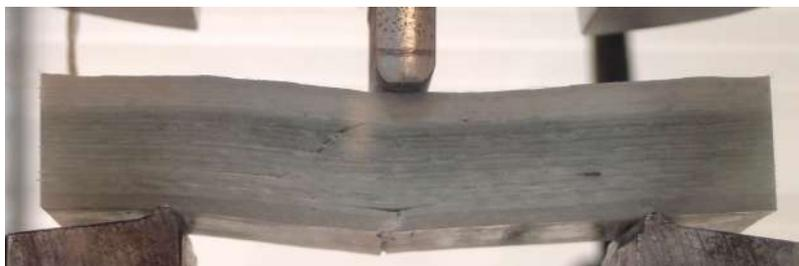
FIGURE 3.64 – Premiers endommagements sur la face tendue de l'éprouvette
