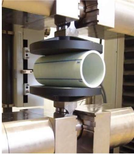
FIGURE 3.21 – Essai de compression circonférentielle
