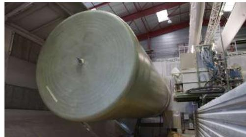
(a) Fond de cuve fabriqué par moulage (b) Intégration du fond lors de l'enroulement
