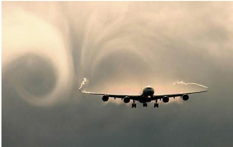
Figure 1.1 Photographie d'un avion et de ses deux tourbillons de sillage créés par la différence de pression entre le dessus et le dessous des ailes.
