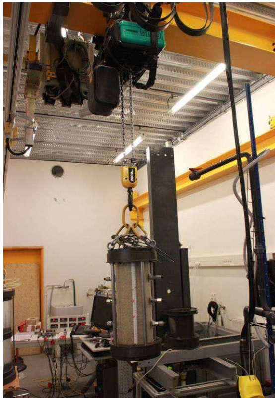
Figure II-37 Soulèvement de la conduite à l'aide du pont roulant
