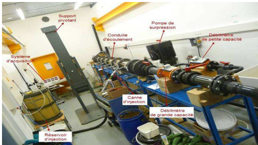
Figure II-3 Vue d'ensemble du dispositif initial d'essai (Truong 2012)
