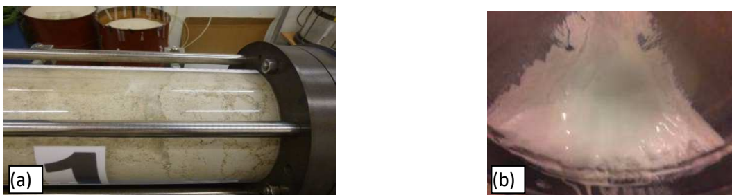
Figure II-7 Quelques problèmes rencontrés dans la configuration horizontale : (a) Effondrement du sol lors de la saturation ; (b) Dépôt dans le cône aval
