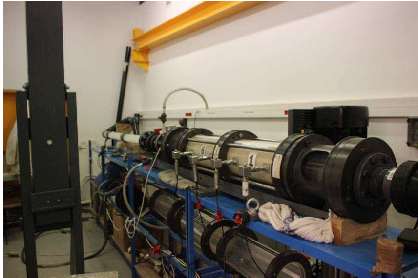
Figure II-35 Raccordement de la conduite sur le reste du circuit
