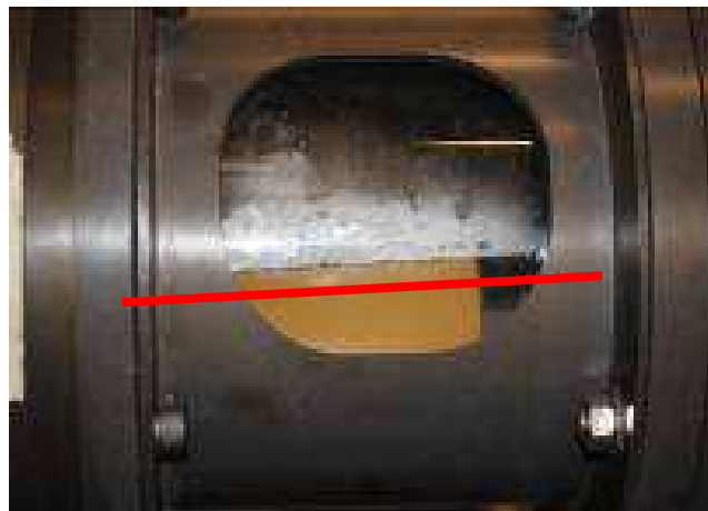
Figure III-13 Vue du défaut de saturation même après la fin de phase d'érosion
