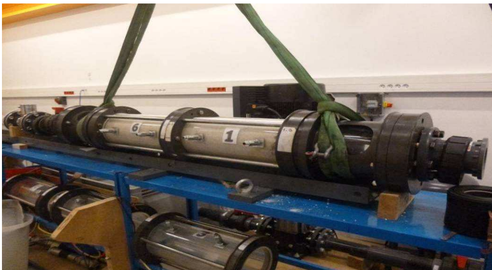
Figure II-34 Installation de la conduite sur son support
