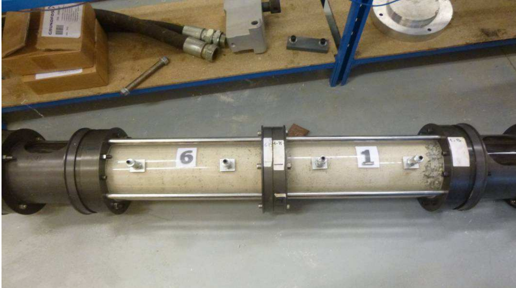
Figure II-33 Montage des cônes amont et aval dans la configuration horizontale
