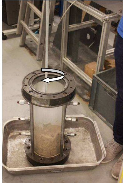
Figure II-31 Compactage rotatif du sol par couches successives
