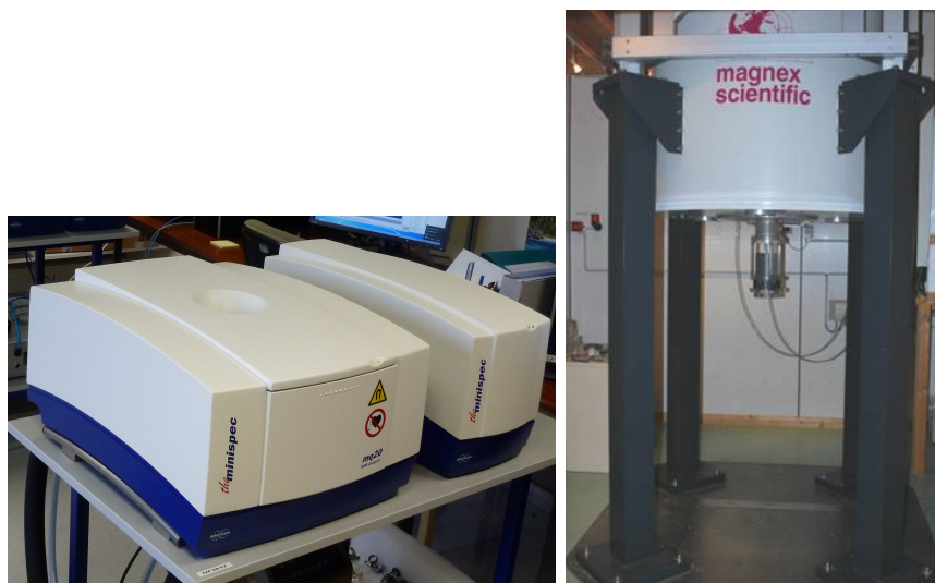
FIGURE 2.21: "Spectromètre de table" Minispec utilisé pour les mesures de relaxivité des particules (à gauche) et spectromètre Imageur par Résonance Magnétique à bas champ utilisé pour la plupart des mesures présentées dans le manuscrit (à droite).
