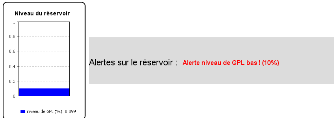
Figure 5-10 Alerte de niveau bas sur le réservoir.
