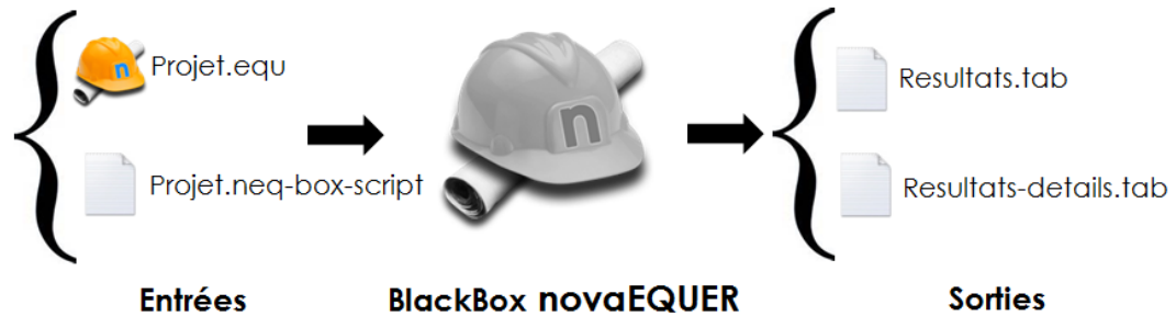
Figure 4-5. Entrées et sorties de la BlackBox novaEQUER
