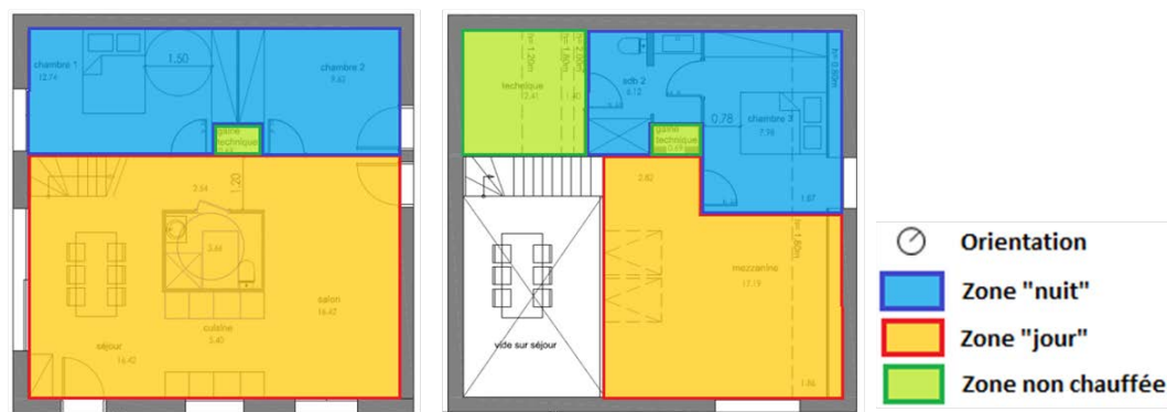
Figure 5-9. Zonage thermique du projet
