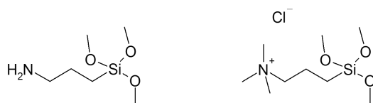
FIGURE 5.11 – Réactifs de silanisation utilisés pour greffer les nanoparticules de silice. A gauche le (3-aminopropyl)triméthoxysilane et à droite le N-triméthoxysilylpropyl-N,N,N-triméthylammonium.
