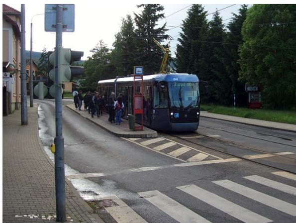
**Figures A-9 et A-10.** Au niveau des quais de la station Kubelíkova, dans les deux directions, les accès sont assurés par des passages piétons faisant partie du carrefour des avenues Kubelíkova et Ještědská et gérés par feux. En direction de la périphérie, le passage est situé correctement pour permettre d'atteindre le quai. – En direction du centre-ville, le passage passe quelques mètres à côté du quai (photos : auteur).
