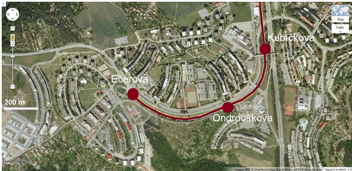
Figure A-39. L'ensemble Bystrc est construit en même temps que son infrastructure de tramway et ses caractéristiques s'inscrivent au design urbain orienté vers le tramway . La plateforme de tramway constitue l'interface entre les trois parties, (d'est en ouest) Bystrc I, II et II A (cartographie : auteur sur fond de plan Google Maps).
