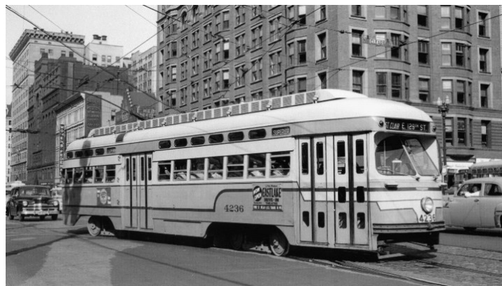
Figure 9. La conception de la rame de type PCC est plus avancée par rapport à celle de ses prédécesseurs. Véhicule extrêmement calme et avec suspension douce, il est capable d'accélérer et freiner rapidement grâce à un système de guidage indirect du moteur (source : Vuchic 2007).
