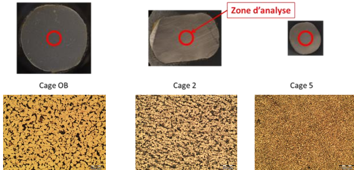
Figure 165 : Micrographies réalisées au cœur du lopin contenant une frette après les cages OB, 2 et 5
