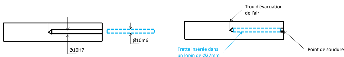
Figure 159 : Illustration de l'exemple du montage de la frette dans le moyeu pour un ajustement \emptyset 10H7m6
