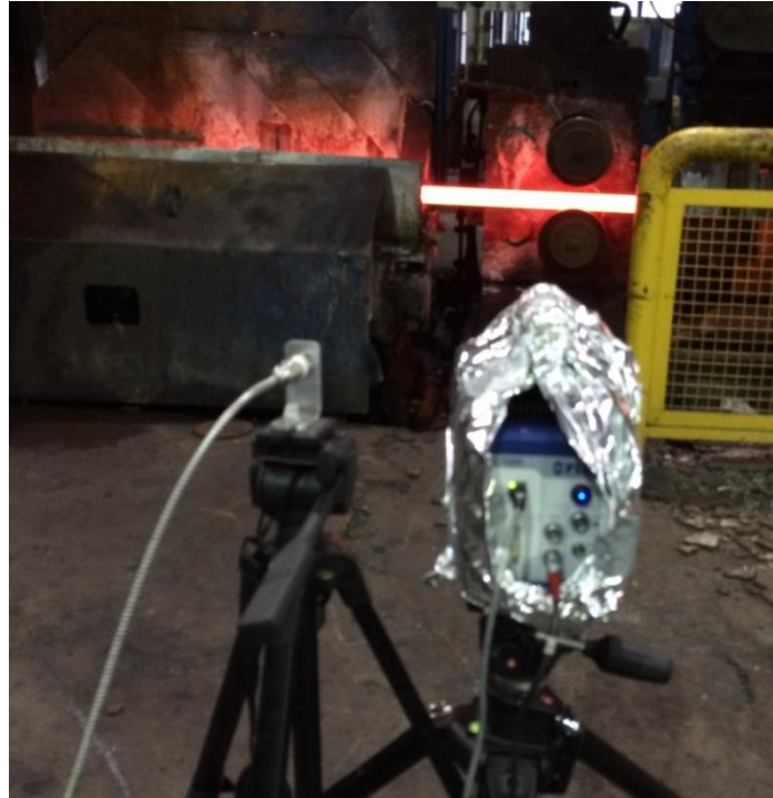
Figure 69 : Relevé de températures avec un pyromètre bi-chromatique et une caméra thermique afin d'évaluer la valeur de l'émissivité
