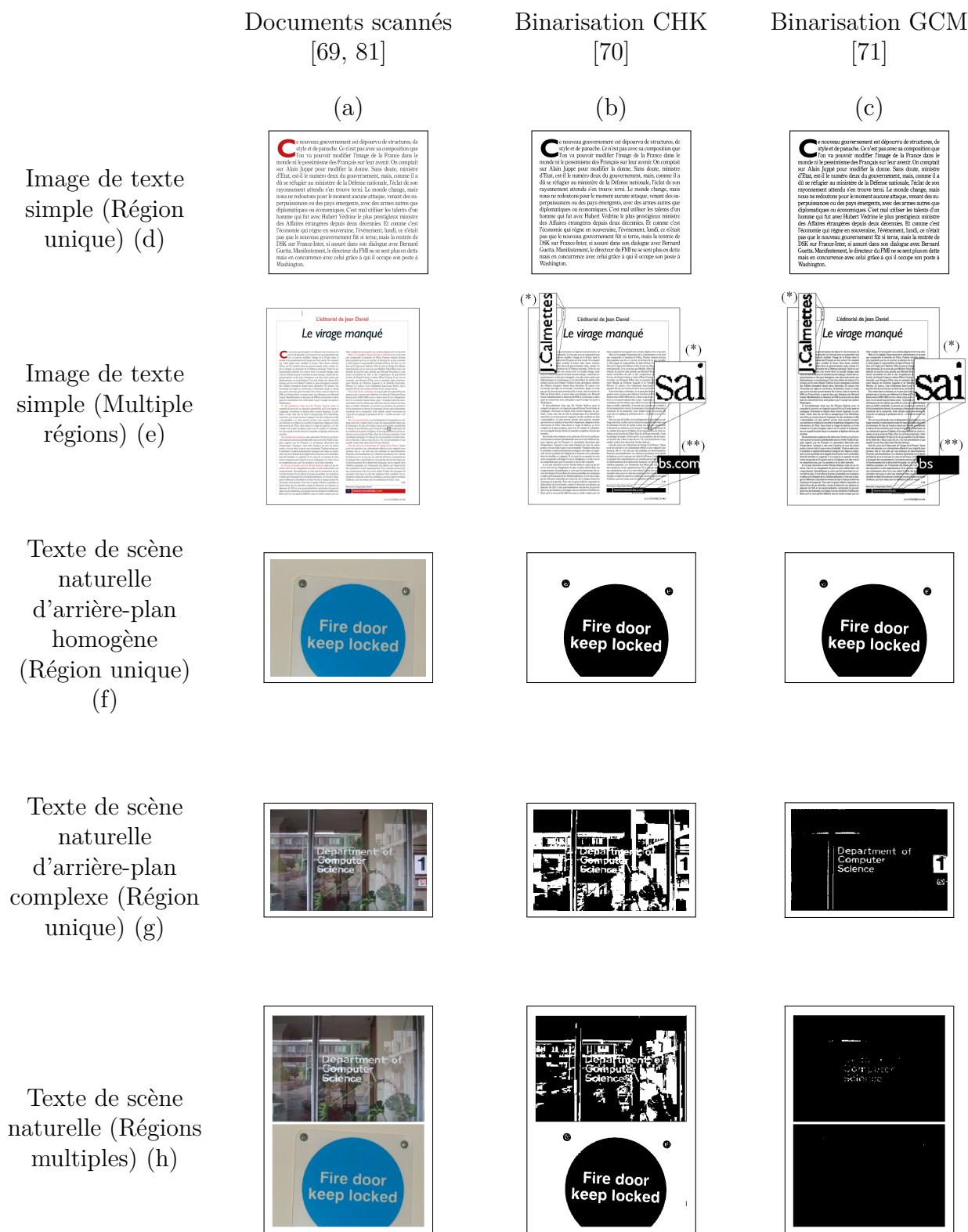
FIGURE 2.27: Évaluation visuelle de l'extraction de texte. (a). Simple et Multiple régions de documents scannées; (b) : Résultats CHK; (c) : Résultats GCM.
