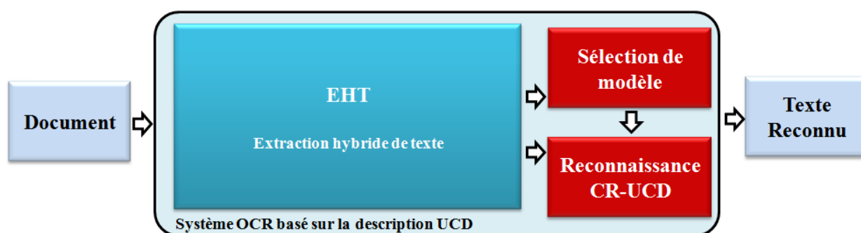
FIGURE 3.13: Schéma fonctionnel de notre Système OCR proposé (CR-UCD).
