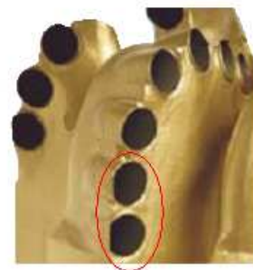
Figure 1.6 : Trimmers dans la garde active
