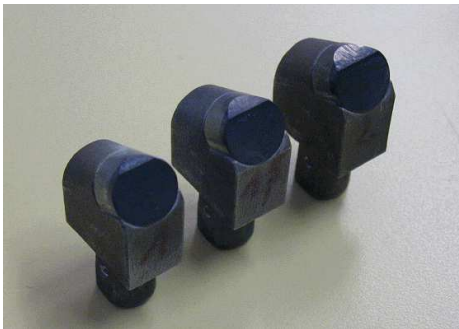
Figure 2.35 : Trimmers PDC de Menand (2001)
