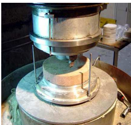
Figure 2.33 : Vue du taillant et de la roche avant la fermeture de la cellule de forabilité du centre de Géosciences de MINES ParisTech
