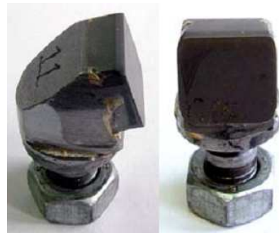
Figure 2.36 : Taillant carré de Pelfrene (2010)
