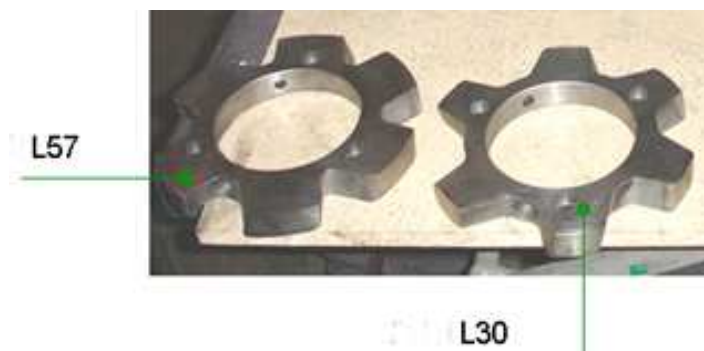
Figure 4.18 : Anneaux « type garde passive » de longueur 1" et de largeur 57 mm (à gauche) et 30 mm (à droite)
