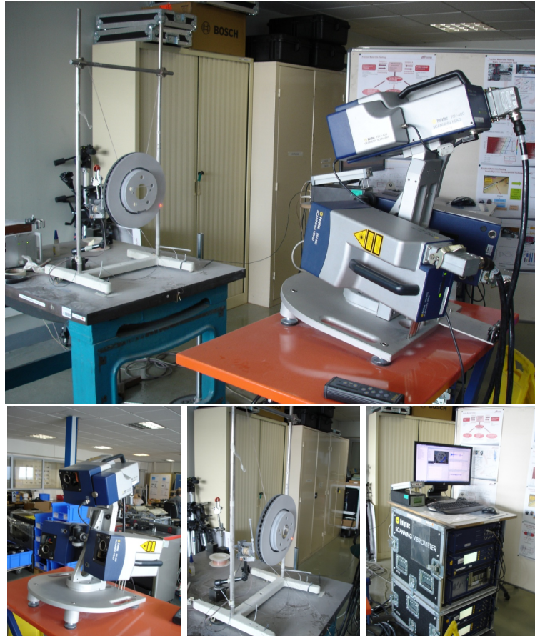
FIGURE 1.2 – Mise en place de la mesure (en haut), dispositif laser (en base à gauche), système mesuré (disque) et marteau (en bas au centre), système d'acquisition (en bas à droite)
