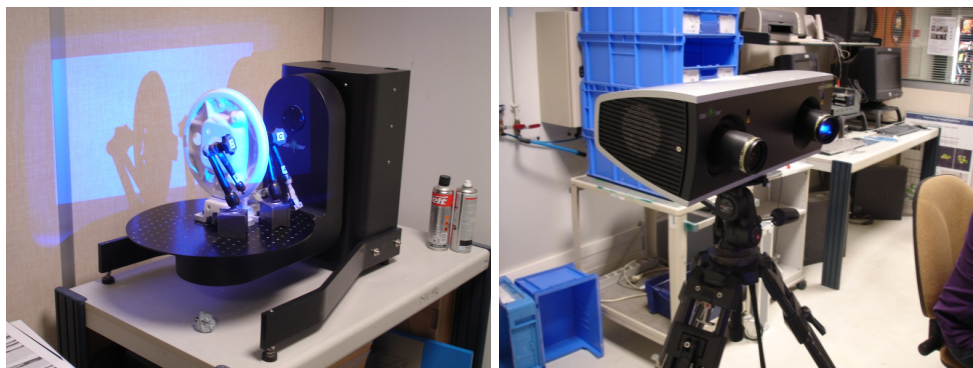
FIGURE 4.2 – Mise en position de la pièce sur le plateau tournant (à gauche), système de mesure COMET L3D (à droite)
