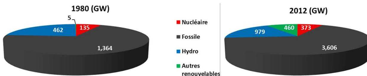
Figure 1-7 : Part des différentes technologies dans la capacité mondiale installée de moyens de production d'électricité en 1980 et 2012.<sup>22,24</sup>
