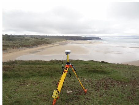
FIGURE 4.11: Base du GPS-RTK Trimble sur l'éperon rocheux de Kerdra séparant les plages de La Palue et de Lostmarc'h. En arrière-plan, plage de La Palue.
