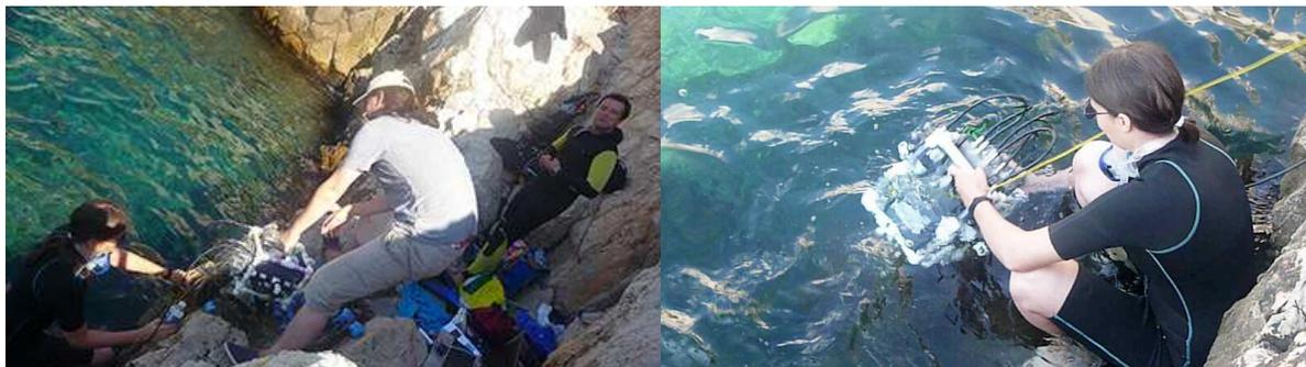
**Figure B.5** – Première mise à l'eau et test d'étanchéité [© L. Avantbey et al.].
