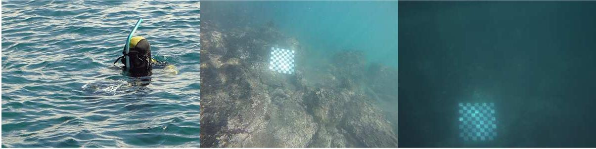
**Figure B.44** – La turbidité étant forte, le plongeur installe la mire sur les rochers, juste en dessous de la surface et procède à l'étalonnage en latéral, à droite une image GoPro et une image uEye [© L. Avantbey et al.].
