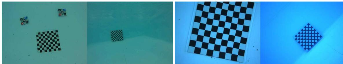
**Figure B.36** – À gauche, deux images d'étalonnage GoPro et à droite deux images uEye, au nadir et en latéral, la distance d'acquisition est la même pour les deux bancs [©ⓃⓁ L. Avantbey et al.].
