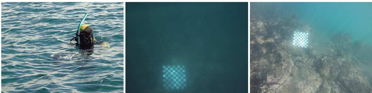
**Figure 4.9** – Calibrage in situ en latéral, avec au centre un exemple tiré du jeu d'images acquis par les caméras uEye et à droite un exemple du jeu acquis par les GoPro [© ⓘ ⓘ L. Avanthey et al.]. La distance d'observation est d'environ 3 mètres pour les uEye et 2,8 mètres pour les GoPro.
