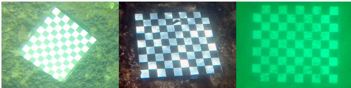
**Figure 3.54** – Exemples de sources d’erreurs possibles pour la détection de la mire lors de l’étalonnage [© L. Avantbey et al.]. De gauche à droite : surexposition due à la trame blanche, passages de poissons devant les points d’intérêt (les couleurs claires les attirent), sable poussé sur le damier par le ressac.
