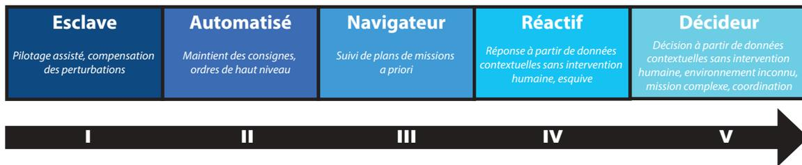
**Figure 2.21** – Cette échelle représente les différents niveaux d'automatisation des plateformes mobiles de télédétection du pilotage manuel assisté à une complète autonomie de réalisation de mission [© 2015 L. Avantbey et al.].
