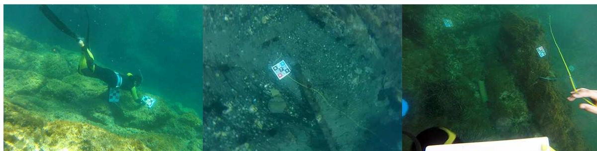
**Figure 4.3** – Établissement du réseau de points de contrôle sur la zone d'étude [© L. Avantbey et al.] : le plongeur répartit les marqueurs sur le fond (à gauche) puis relève les distances qui les séparent. Pour cela, il dépose le plomb sur le coin d'un marqueur (au centre) et déroule la corde (à droite) jusqu'au coin d'un autre marqueur. Un brin numéroté noué permet d'enregistrer la mesure et ses références sont notées sur l'ardoise.
