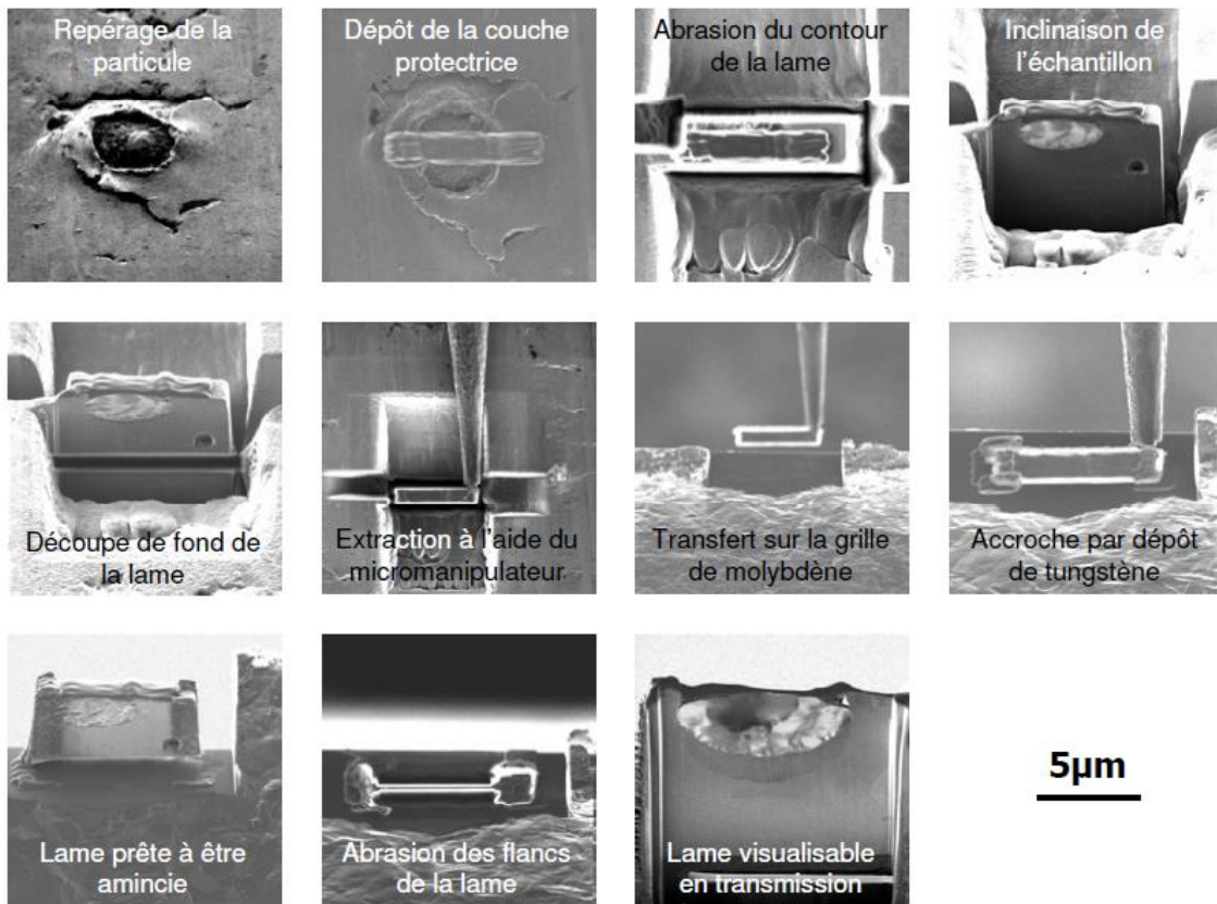
Figure II.8 : Etapes de prélèvement d'une lame mince par FIB [GUE10]. Images FIB vues de dessus et de côté.
