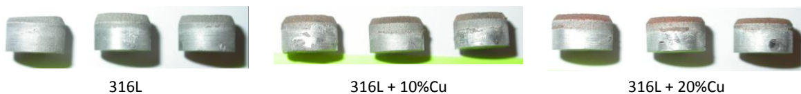
Figure II.12 : Echantillons formés de revêtements cold spray sur des pastilles d'aluminium avec la composition du mélange de poudres utilisé lors de la projection.
