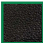
Rugosité Centre : 10X Cutoff 2,50 mm (par ligne), résolution 0,02mm, objectif 50mm
