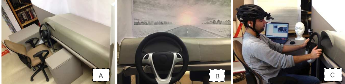
Figure 69 : (A) Cockpit simulé ; (B) Tableau de bord et panneau scénographique ; (C) Participant installé.
