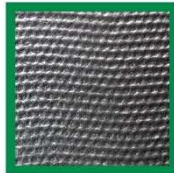
Rugosité Poignée : 7X Cutoff 2,50 mm (par ligne), résolution 0,02mm, objectif 50mm
