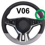
Rugosité Poignée : 11X Cutoff 2,50 mm (par ligne), résolution 0,02mm, objectif 50mm
