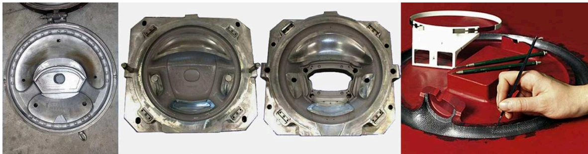
Figure 25 : Exemples de moules pour injection de pièces automobiles texturées.
