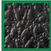
Rugosité Centre : 7X Cutoff 2,50 mm (par ligne), résolution 0,02mm, objectif 50mm
