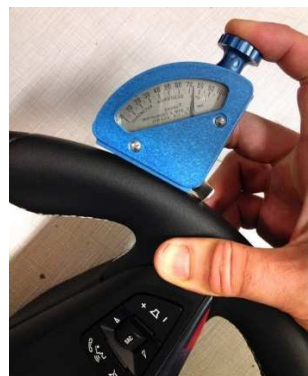
Figure 102 : Mesure de la dureté avec le duromètre analogique - EXP3B.
