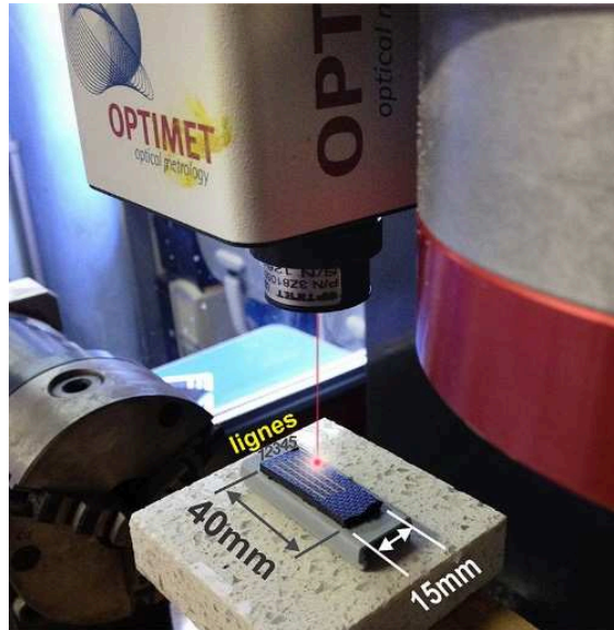
Figure 97 : Numérisation des lignes sur les échantillons des volants.
