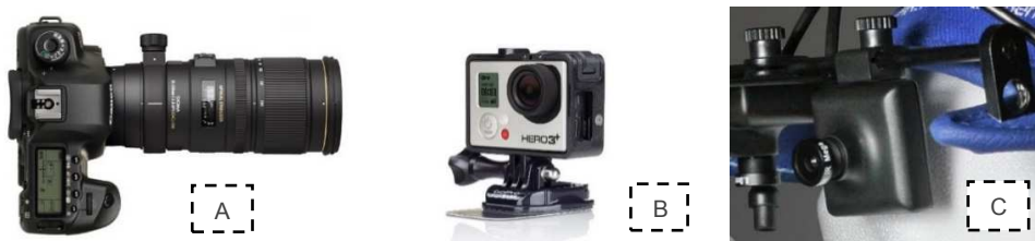
Figure 72 : Cam1 : (A) Camera reflex capteur full frame + objectif 70-200mm ; Cam2 : (B) Camera grand angle full HD ; Cam3 : (C) Camera VGA pour le dispositif d'eye-tracking
