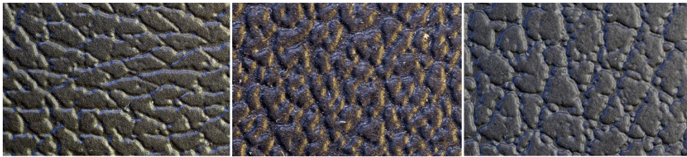
Figure 1 : Exemples de textures standards dans le secteur automobile (photographie macro 2:1).
