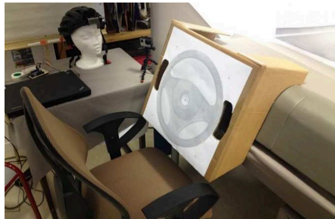
Figure 73 : Dispositif de calibration de l'eye-tracking - EXP2.
