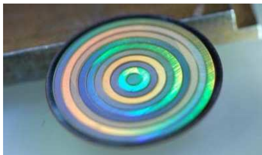
Figure 26 : Effet optique (diffraction de la lumière) de la nanotexturation sur l'acier inoxydable.
