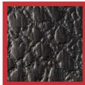
Rugosité Centre : 7X Cutoff 2,50 mm (par ligne), résolution 0,02mm, objectif 50mm
