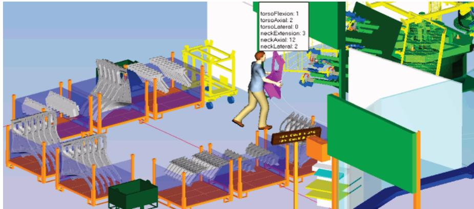
Figure V.9 – Revue dynamique d'une zone de chargement
