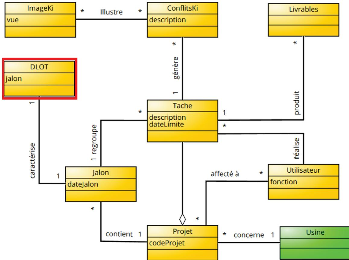
Figure V.2 – Modèle de données d'une revue numérique DLOT
