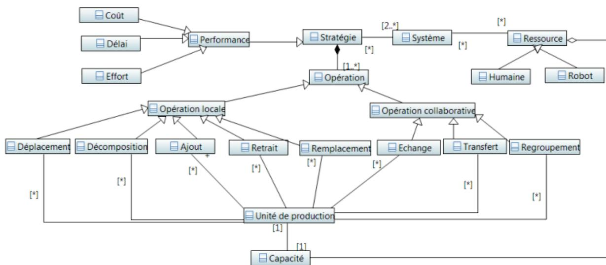
Figure III.18 – Métamodèle de la méthode de reconfiguration progressive
