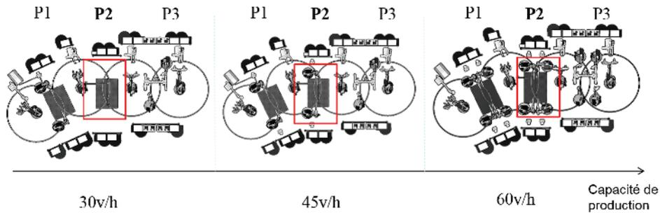
**Figure III.6** – Configurations d'une ligne d'assemblage de plancher central
