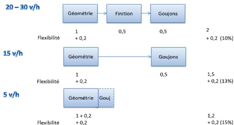
**Figure III.7** – Schéma de configurations de ligne d'assemblage de plancher central
