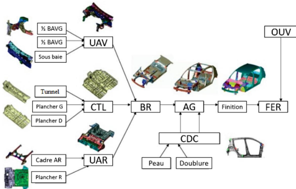
Figure I.2 – Processus d'assemblage de caisse automobile
