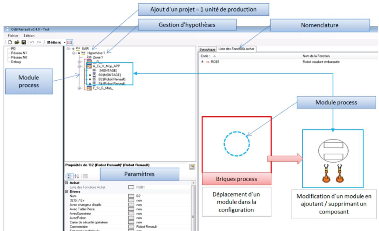
Figure V.6 – Interface de configuration d'un processus d'assemblage
