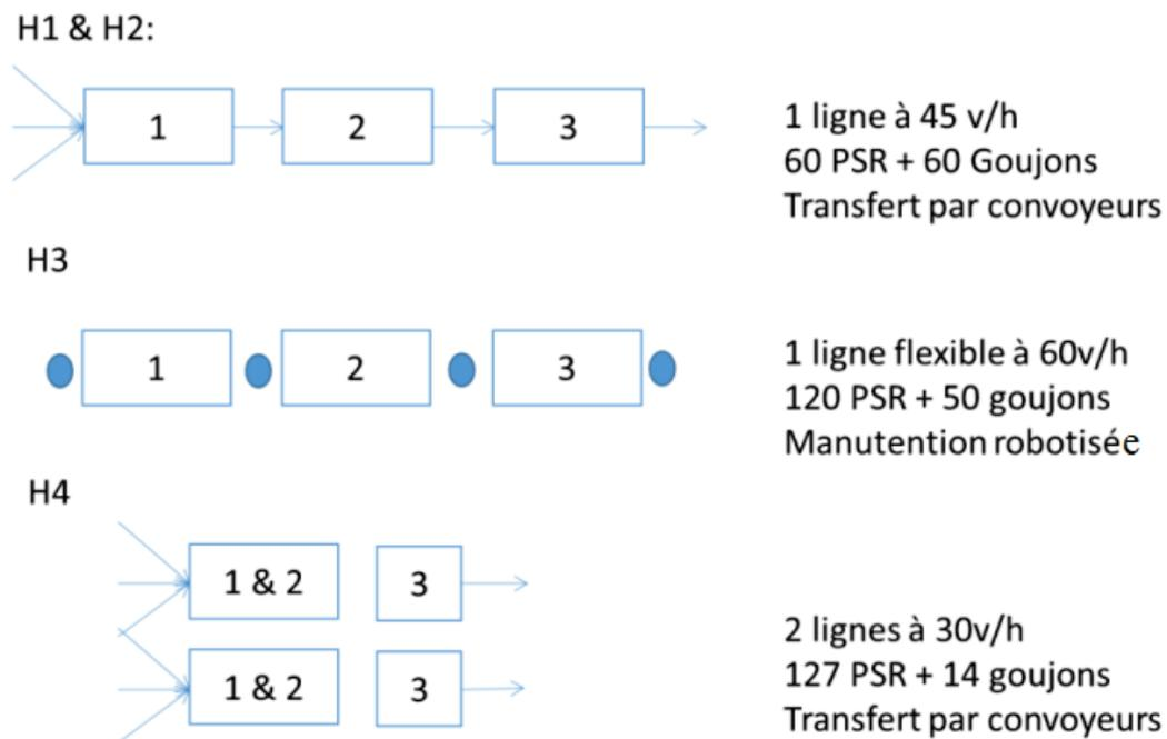
Figure IV.4 – Configuration d'une unité d'assemblage de plancher central
