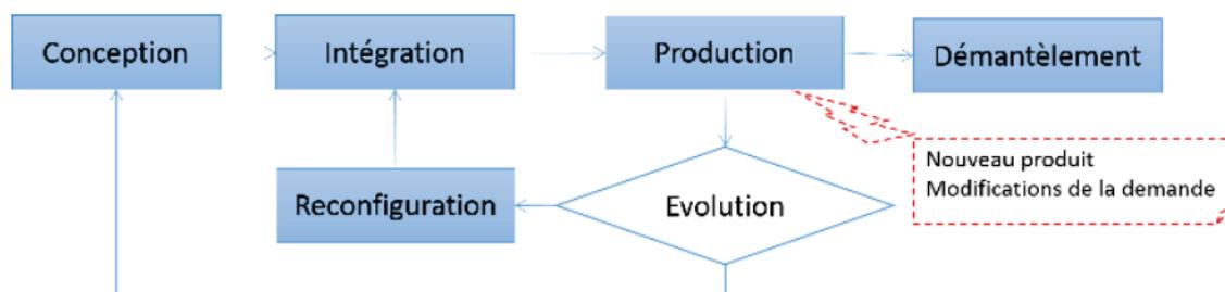
**Figure I.6** – Etapes du cycle de vie d'un système industriel
