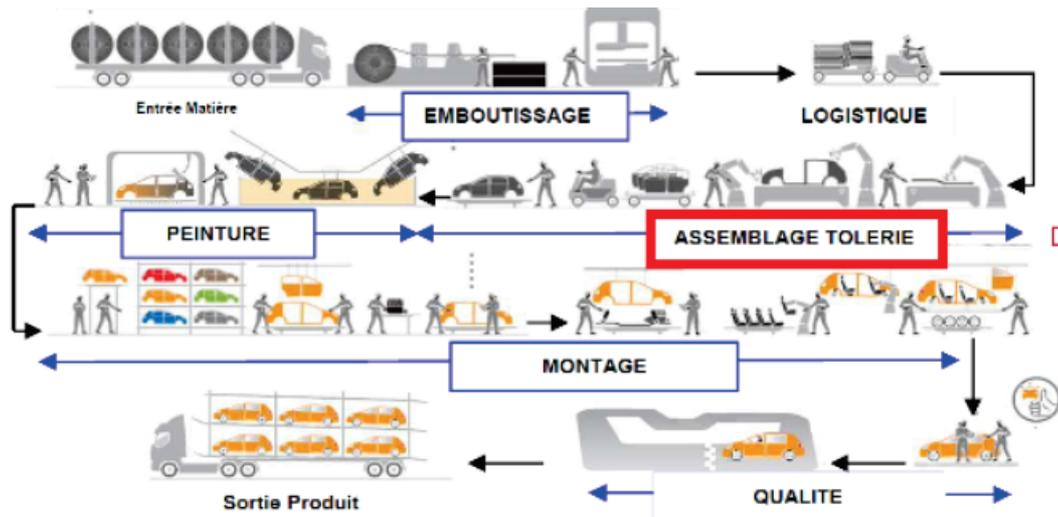
Figure I.1 – Etapes de fabrication d'un véhicule
