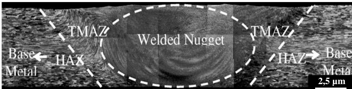
Figure I. 3 Macrographie de la zone soudée [Mis05]
