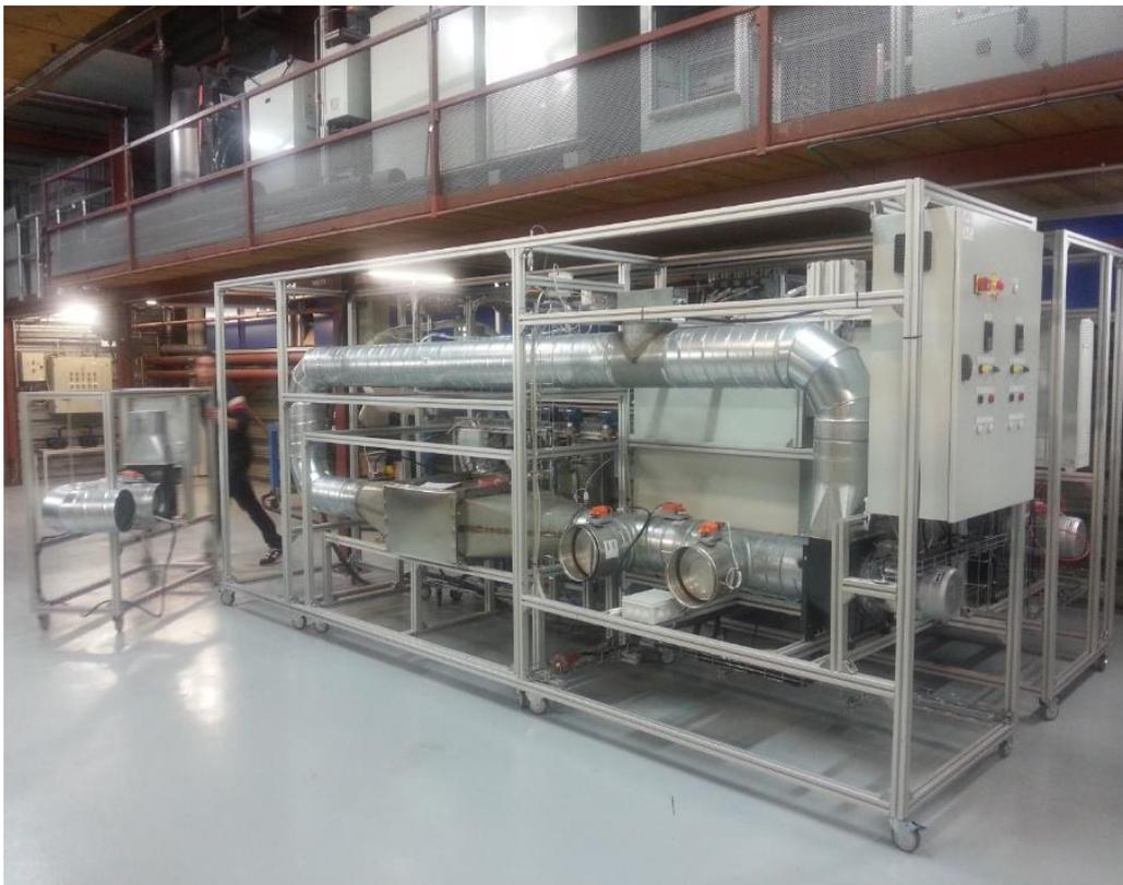
Figure 4.15: Photographie du banc d'essai côté boucle aéraulique chaude. Sont visibles, les deux ventilateurs et une armoire de contrôle à droite, le refroidisseur de gaz, le système de registre permettant de contrôler la température de retour d'air et une résistance chauffante au centre.
