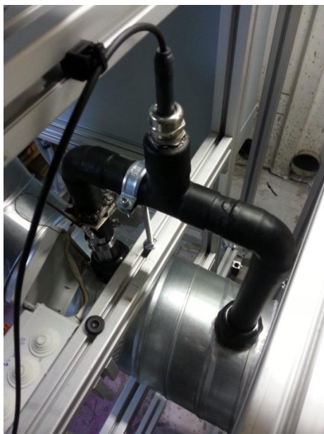
Figure 4.11: Système de piquage permettant une mesure plus précise de l'humidité relative d'un air proche de la saturation
