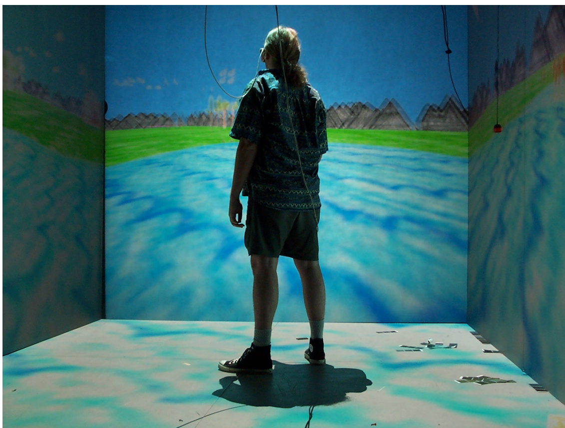
FIGURE 6.1 : Le système immersif CAVE
