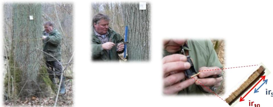
Figure 1.9 : De gauche à droite, mesure de circonférence, carottage et lecture d' $ir_5$  et  $ir_{10}$  sur le terrain
