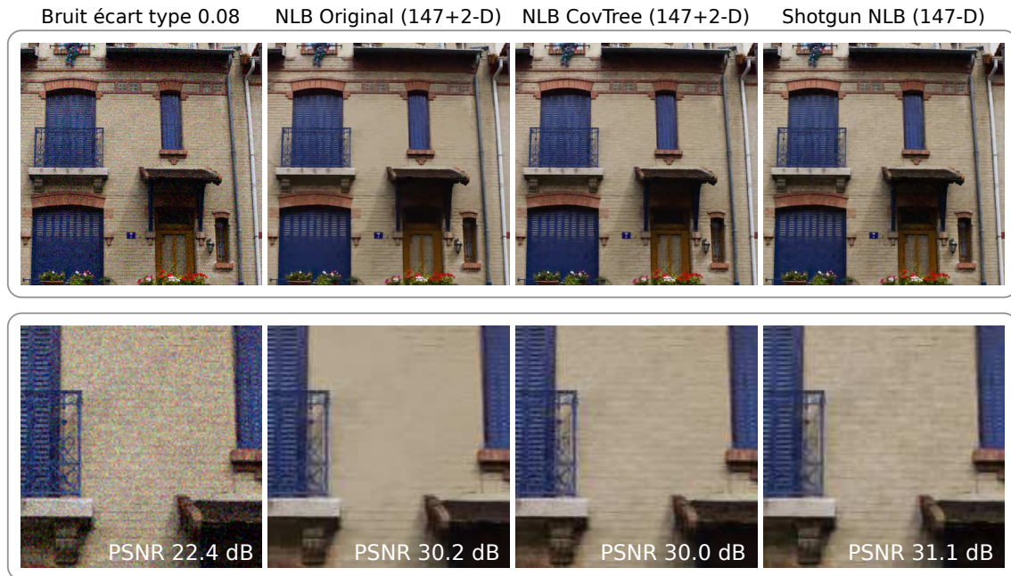
FIGURE 5.9: Comparaison des images débruitées obtenues pour différentes versions des NLB : le NLB original, notre CovTree NLB et notre Shotgun NLB. La deuxième ligne présente des agrandissements des résultats obtenus sur la première ligne.
