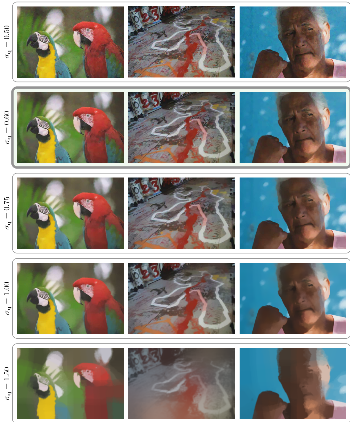
FIGURE 5.2: Restaurations d'une image corrompue par un bruit additif gaussien d'écart type 0.2 obtenues pour différentes échelles d'estimation de la gaussienne anisotrope \sigma_{\mathbf{q}} . Plus la taille \sigma_{\mathbf{q}} est élevée plus la gaussienne anisotrope résultante est grossière. La taille idéale pour estimer la matrice de covariance est représentée en gras. Contrairement au NLB, la taille du voisinage peut être changée sans nécessiter de calculs supplémentaires.
