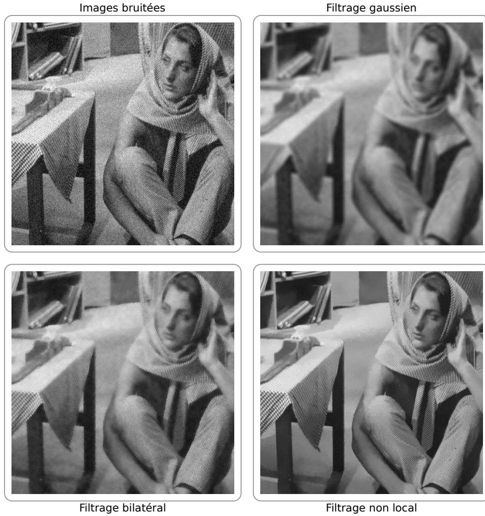
FIGURE 2.2: Résultat des différents filtrages gaussien, bilatéral et non local appliqués sur l'image barbara bruitée avec un bruit gaussien de variance 0.08.
