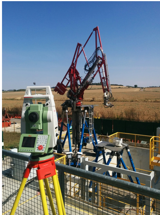
FIGURE B.7 : La station total mesure la position du coupler. Photographie de la maquette OLAF.
