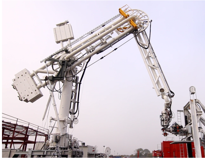
FIGURE B.21 : Le bras de chargement est connecté avec succès au banc de test.
