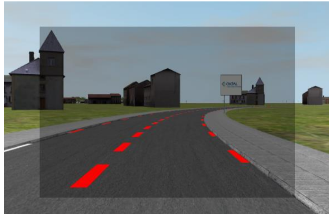
Figure 6.1. ATH-RA augmentation des lignes de marquage au sol
