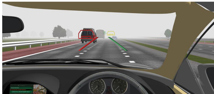
Figure 3.3 Effet visuel d'une erreur de calibration offset de 2cm (Charissis & Naef, 2007)
