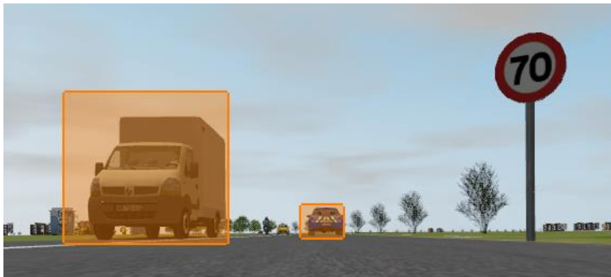
Figure a1.2 Affichage HUD Virtuel «encadrement des voitures devant le conducteur»
