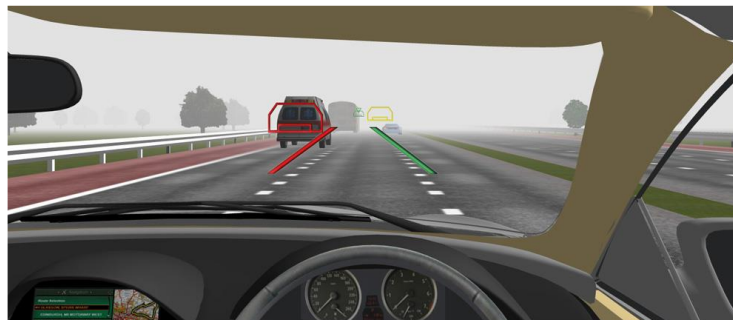
Figure 3.3 Effet visuel d'une erreur de calibration offset de 2cm (Charissis & Naef, 2007)
