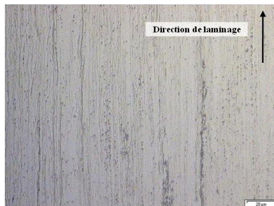
Figure 3-54 : Micrographie optique (coupe longitudinale) du tube ODS ferritique issu de la gamme basse température (code SRMA J37).
