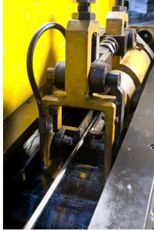
Figure 0-1 : Banc de laminage à pas de pèlerin de type HPTR du CEA.
