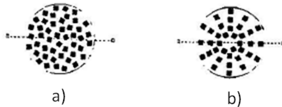
Figure 1-31 : Schémas de l'orientation des grains selon une coupe transversale : a) texture de type fibre, et b) texture cyclique [Réglé 1994].
