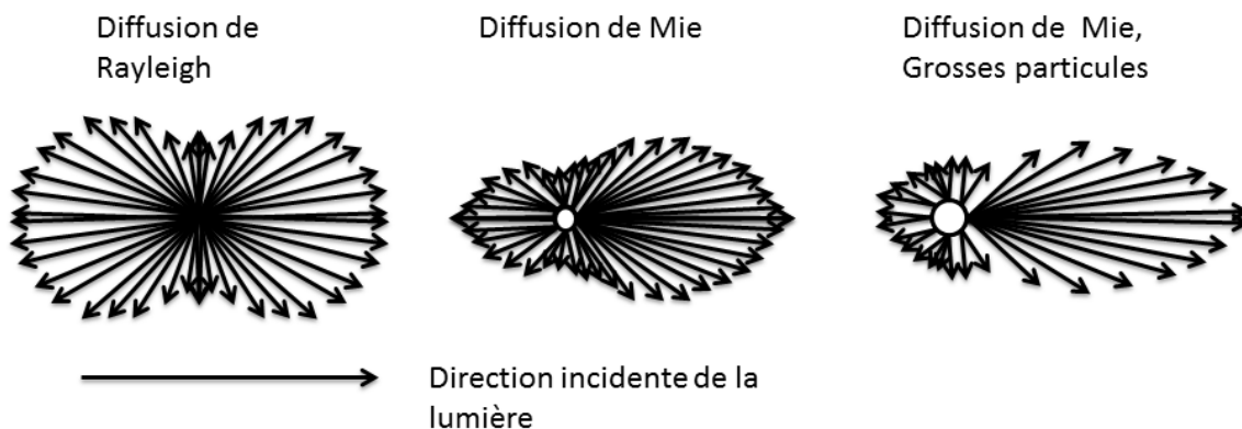
Figure II-5 : Régime de diffusion de la lumière dépendant de la longueur d'onde du rayonnement et de la taille de la particule diffusante. Plus la particule est grande devant la longueur d'onde, plus la diffusion est directionnelle.
