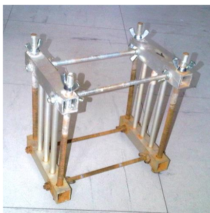
Figure 41 : Portoir en inox pour échantillonneurs passifs
