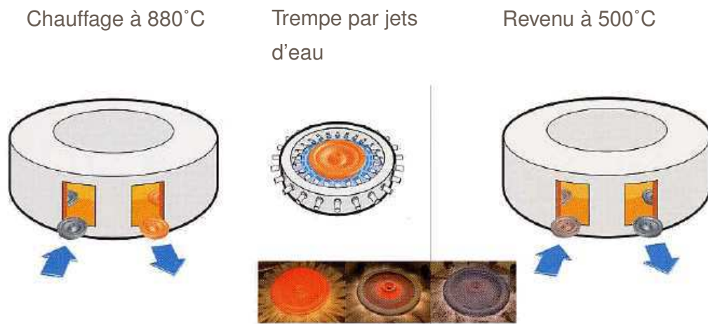
FIGURE 1.4 – Traitements thermiques (Document Valdunes)
