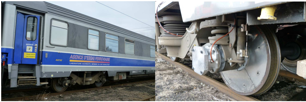
FIGURE 4.5 – Train et essieu instrumenté
