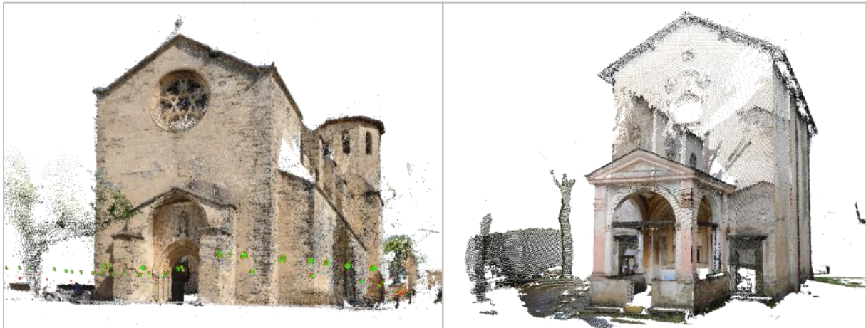
Figure 36 : Nuage de points final par photogrammétrie : église Saint Maurice (à gauche), Chapelle Notre-Dame des Fontaines (à droite).
