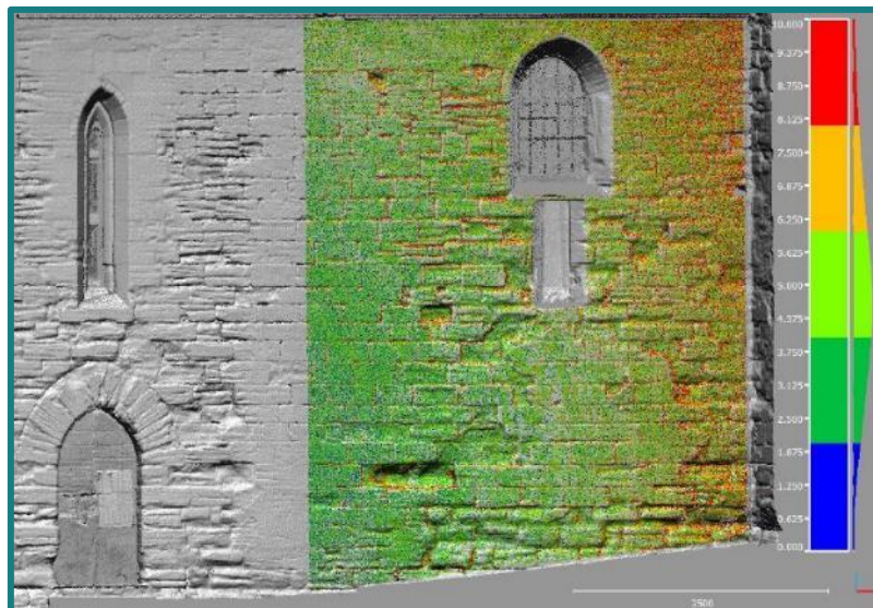
Figure 130 : Carte C2C entre nuage de points issu du scanner et celui issu de la reconstruction photogrammétrique ; partie de la façade Est de l'église Saint Maurice [Nespeca R. et al., 2016].
