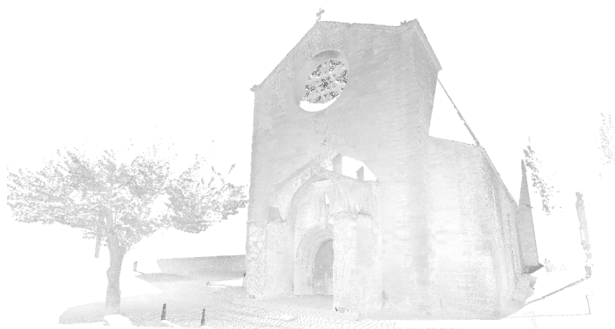
Figure 31 : Nuage de points obtenu après recalage des stations, intensité en niveaux de gris : Église Saint-Maurice.
