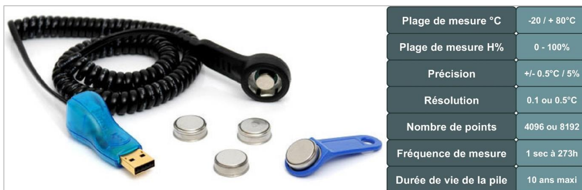
Figure 28 : Thermobouton pour l'acquisition climatique (thermique, hygrométrique) et ses caractéristiques techniques.
