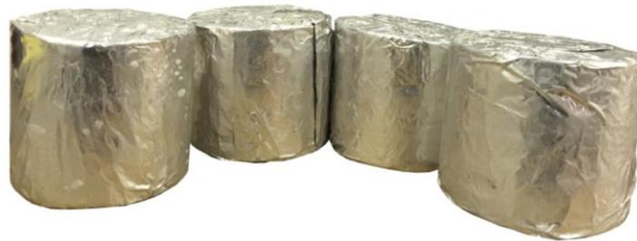
**Figure 1-20. Bouts de carotte de l'Argile à Opalinus préparés pour échantillonnage.**
