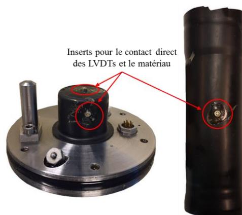
*Figure 1-23. Inserts pour assurer le contact direct entre l'échantillon et le LVDT.*
