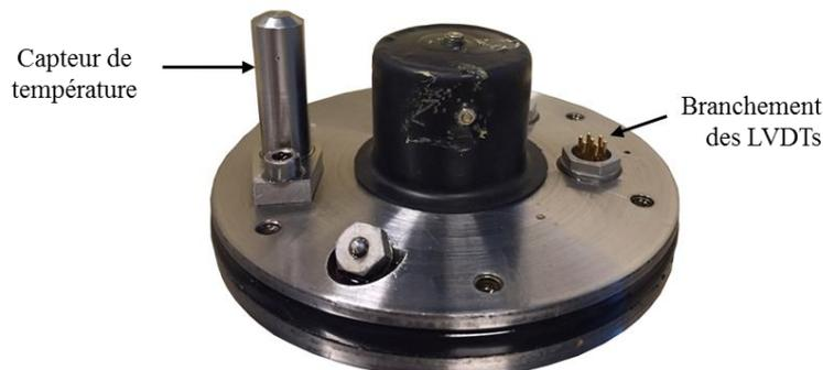
**Figure 1-12. Mise en place de l'échantillon dans la cellule isotrope.**
