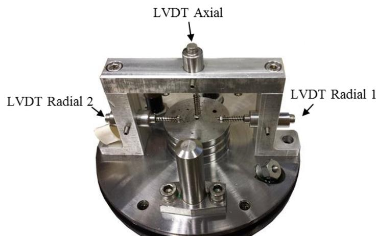
*Figure 1-10. Système de mesure locale des déformations dans la cellule isotrope.*
