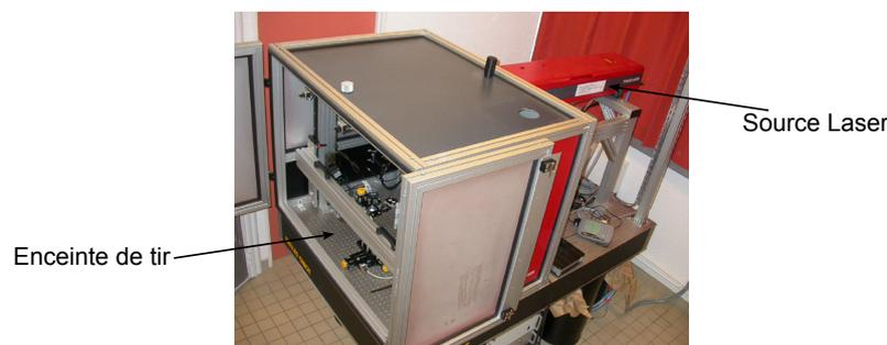
FIGURE 2.5 – Dispositif LASAT du Centre des Matériaux
