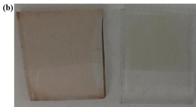
**Figure II- 14 :** (a) Spectre d'absorption de films de spiro-OMETAD avec ajout de 0, 5 et 17  $\mu\text{L}$  d'une solution de Li-TFSI (520 mg/ml dans l'acétonitrile) obtenu juste après le dépôt et 24 heures après stockage en milieu ambiant et (b) aspect du film avec 0  $\mu\text{L}$  (à droite) et 17  $\mu\text{L}$  (à gauche) 24 heures après le dépôt des films.
