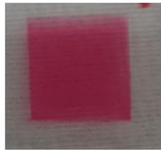
*Figure II- 5 : Photographie du film de ZnO nanoporeux juste après son retrait du milieu réactionnel.*
