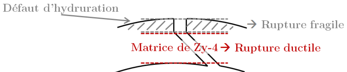
Figure 51 : Profil de rupture à 350°C d'une gaine de Zy-4 hydruré contenant un défaut d'hydruration
