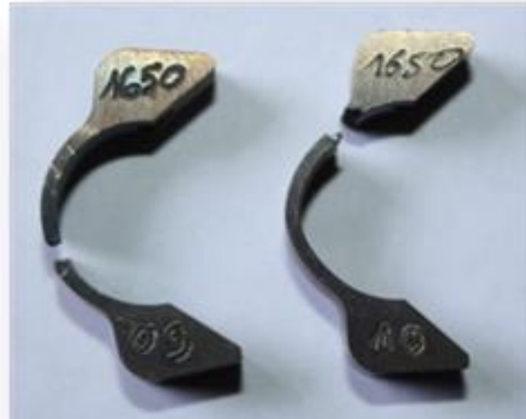
Figure 200 – Eprovettes OCR rompues après 2000h en milieu primaire à 360°C et 30 mL H 2 /kg H 2 O (B369)
