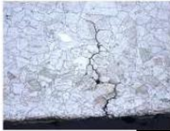
Figure 5 – Fissure de CSC observée dans l’attente de plaque (en alliage 600 laminé à chaud) du GV1 de Chinon B1 [MONCHECOURT11]
