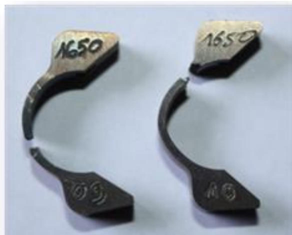
Figure 200 – Eprouvettes OCR rompues après 2000h en milieu primaire à 360°C et 30 mL H 2 /kg H 2 O (B369)
