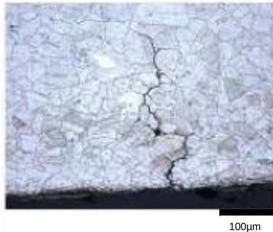
Figure 5 – Fissure de CSC observée dans l'attente de plaque (en alliage 600 laminé à chaud) du GV1 de Chinon B1 [MONCHECOURT11]
