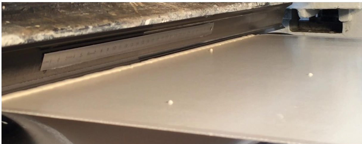
Figure 102 : Apparition de gouttes en aval de la racle, relarguées sur le substrat
