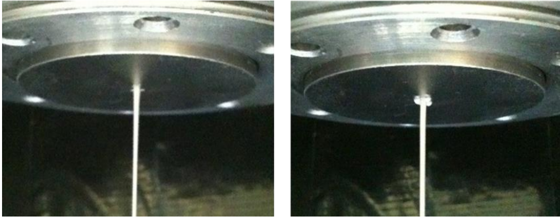
Figure 131 : Sortie de filière plate : sans et avec dépôt sur les bords
