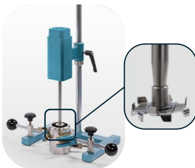
Figure 30 : Mélangeur Dispermat et type d'hélice utilisés dans cette étude
