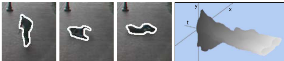
FIGURE 3.9 – Construction d'une surface 3D à partir de silhouettes issues de plusieurs images consécutives (©Yilmaz et Shah [142])
