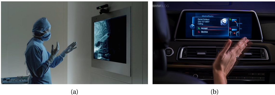
FIGURE 1.3 – Interaction avec des systèmes intelligents via des gestes. (a) : Avec un écran dans un bloc opératoire, (b) : Avec un gestionnaire de commandes dans l'habitacle d'une voiture
