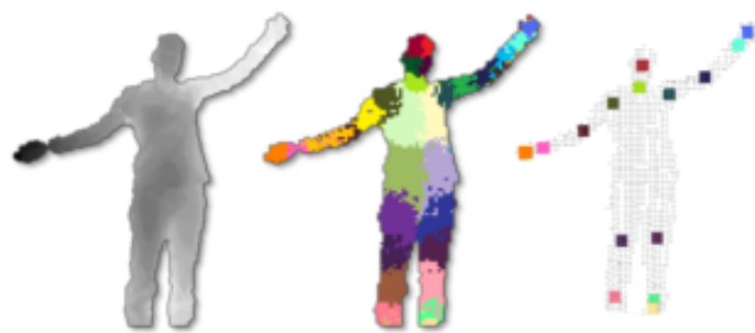
FIGURE 3.12 – Illustration des travaux de (©Shotton et al. [117]) : à gauche : une personne filmée avec une caméra de profondeur, au centre : les pixels après classification, à droite : position des articulations
