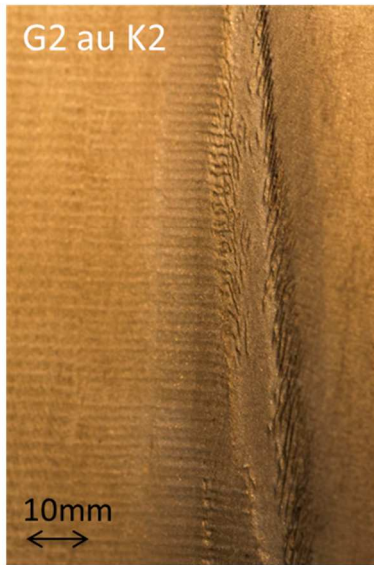
Figure 4-37 – Photo de détail du défaut. Exemple : coin « corps de bielle » défaut sur les facettes de pénétration. Outillage inférieur, segment 21. Voir Figure 4-36
