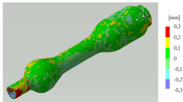
Figure 2-18 – Comparaison de la géométrie de la pièce laminée issue des deux simulations avec une mise en données identique
