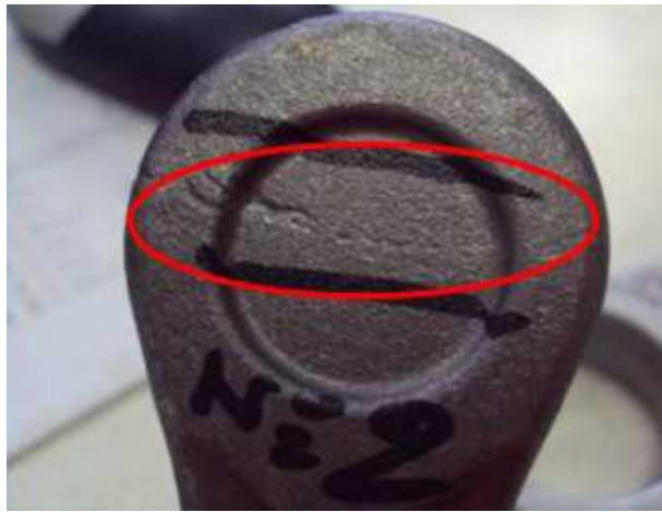
Figure 4-17 – Défaut sur la bielle : rayures superficielles
