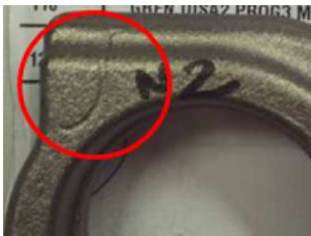
Figure 4-18 – Défaut sur la bielle : paille
