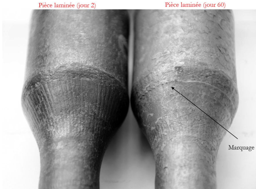
Figure 4-12 – Défaut de surface dû à l'usure de l'outillage dans la réduction du corps de bielle (N2)
