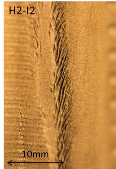
Figure 4-37 – Photo de détail du défaut. Exemple : coin « corps de bielle » défaut sur les facettes de pénétration. Outillage inférieur, segment 21. Voir Figure 4-36
