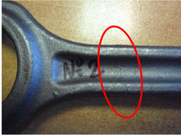
Figure 4-16 – Défaut sur la bielle : repli travers
