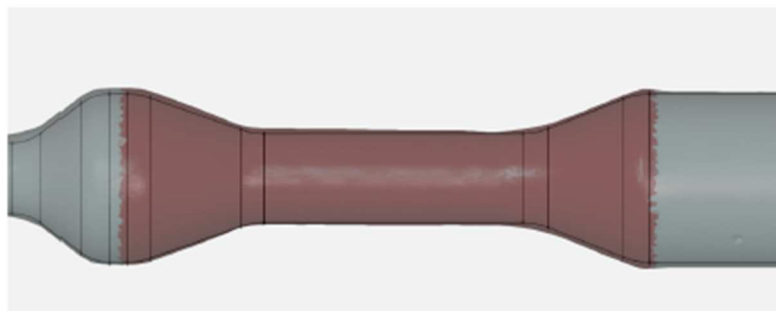
Figure 4-68 – Phénomène de conicité. Alignement local dans le corps de bielle
