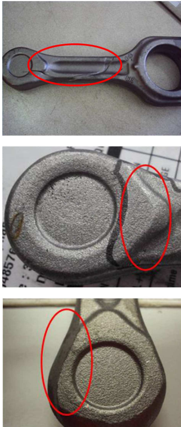
Figure 4-15 – Défaut sur la bielle : mauvais remplissage de matière
