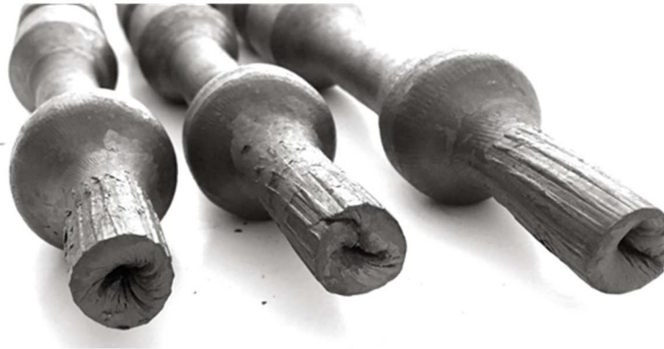
Figure 2-39 – Forme de tulipe à l'extrémité de la pièce en simulation et dans la réalité
