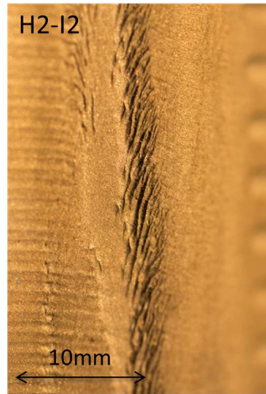
Figure 4-37 – Photo de détail du défaut. Exemple : coin « corps de bielle » défaut sur les facettes de pénétration. Outillage inférieur, segment 21. Voir Figure 4-36
