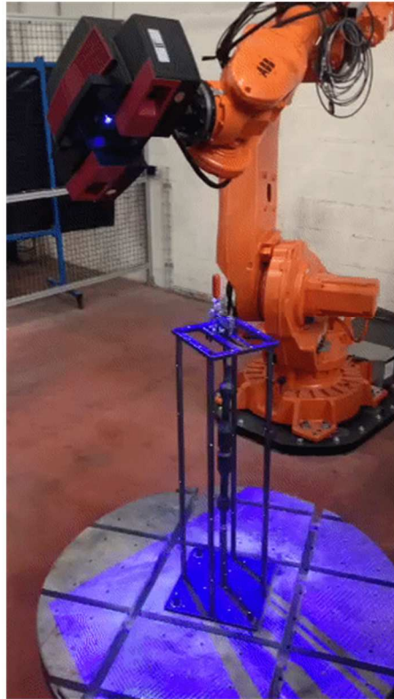
Figure 4-59 – (a) CAO du montage utilisé pour la mesure 3D de pièces laminées et (b) installation du montage sur le plateau rotatif
