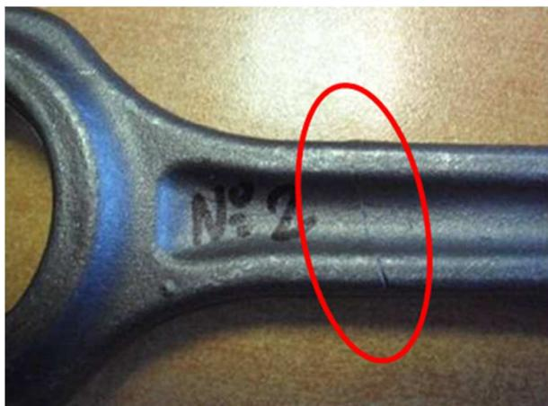
Figure 4-16 – Défaut sur la bielle : repli travers
