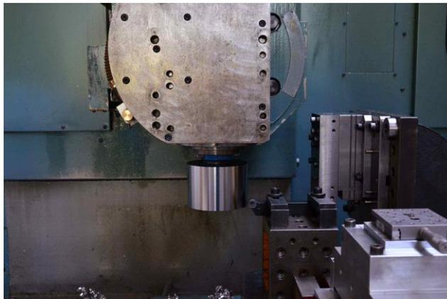
Figure 3.10 - Mise au diamètre du lopin pour polissage et attaque de sa surface.
