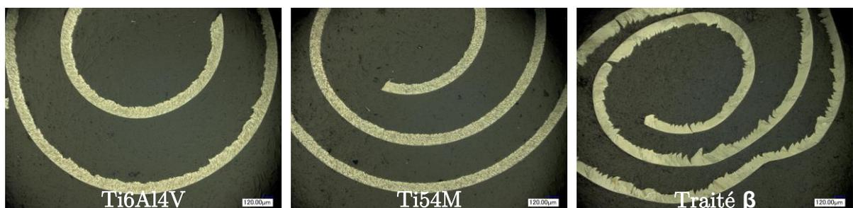
Figure 2.16 – Analyse post-mortem de la morphologie globale des copeaux lors des essais de rabotage ( $V_c = 10 \text{ m.min}^{-1}$ ).
