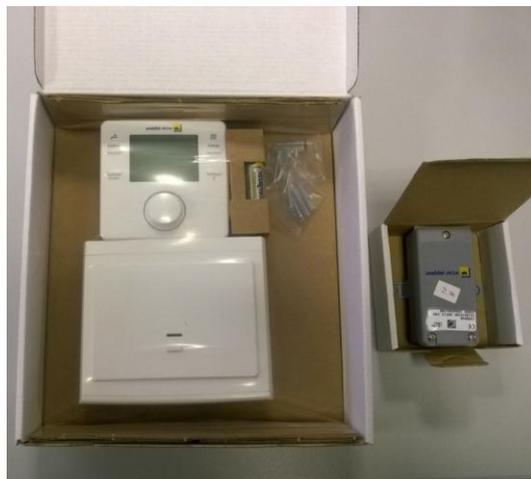
Figure 36 : Thermostat d'ambiance développé comme support physique de la connectivité dans l'offre Optibox
