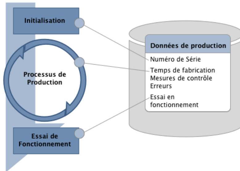
Figure 61 : Principe de collecte des données sur le processus de fabrication
